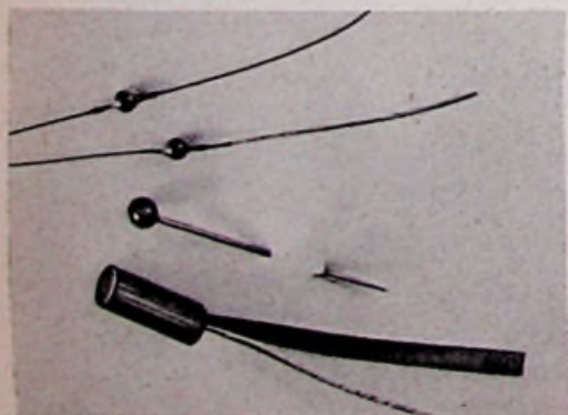
Bild 4. Zwei Subminiaturdioden der Howaldts-Werke im Vergleich zu einem Stecknadelkopf, daneben eine Germanium-Stromventil (Flächendiode)
